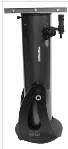
**Figure 9.** Une fois que la base est de niveau, pointez le tube jusqu'à ce que la cellule de miroir entre en contact avec la butée verticale. Ensuite, placez le niveau à bulle sur toute la partie supérieure du tube, comme illustré. Si la butée verticale est réglée correctement, la partie supérieure du tube doit également être de niveau.
