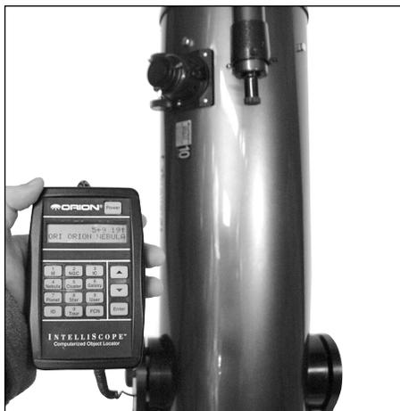
**Figure 10.** Si vous vous tenez à gauche de la lunette et faites face à la direction vers laquelle est orienté le tube, les flèches de guidage correspondront exactement à la direction vers laquelle vous devez déplacer le télescope afin de trouver l'objet sélectionné.
