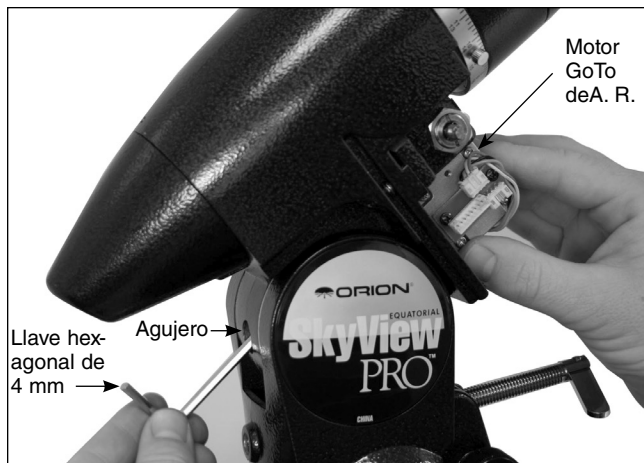
Figura 4. Colocación del motor GoTo de A. R.
