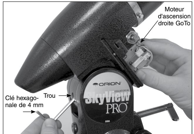
**Figure 4.** Fixation du moteur d'ascension droite GoTo
