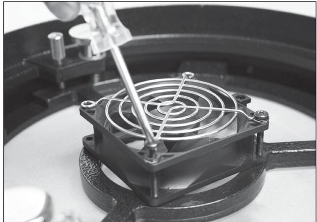
**Abbildung 4b.** Befestigen des Lüfters an der Spiegelzelle.
