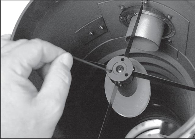
**Abbildung 13.** Die Neigung des Sekundärspiegels wird mit einem 2-mm-Inbusschlüssel und den drei Stellschrauben um die Kreuzschlitzschraube in der Mitte angepasst.
