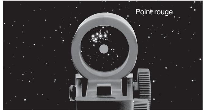
**Figure 13.** L'EZ Finder II superpose un petit point rouge dans le ciel, indiquant l'endroit exact où le télescope est pointé.
