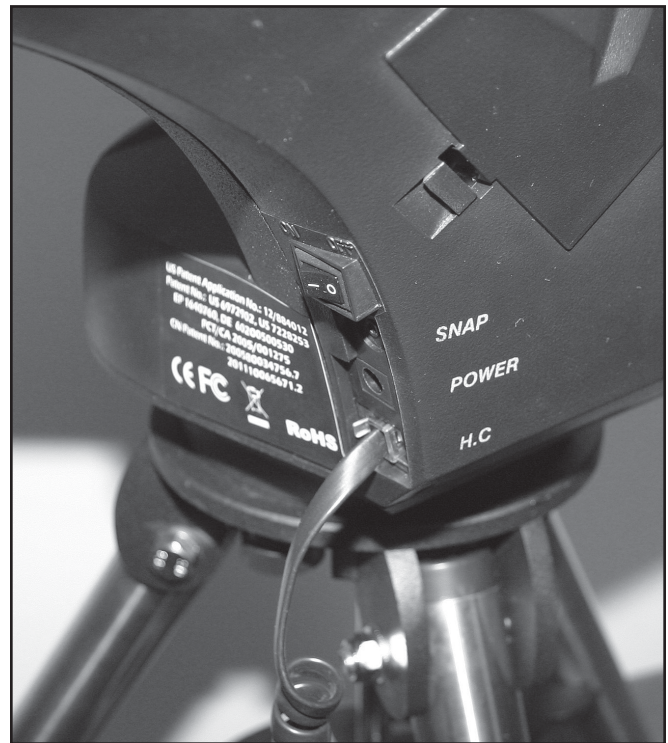
Abbildung 16 Die elektronischen Anschlüsse für die Handsteuerung und eine optionale 12 V DC Batterie sind an der Basis der Montierungsarms angebracht. Der SNAP-Anschluss ermöglicht die Steuerung einer DSLR-Kamera, wenn sie mit einem geeigneten Kabel verwendet wird.
