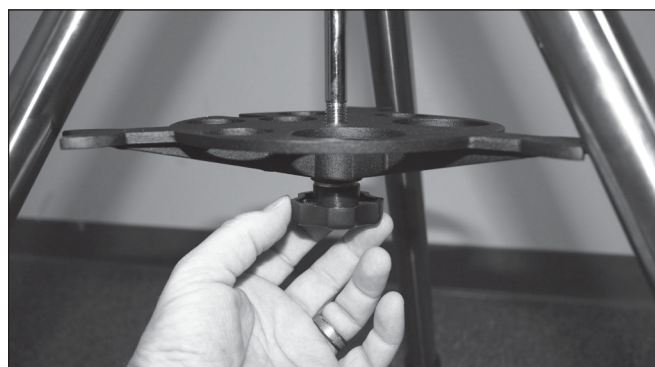
Abbildung 3. Installieren Sie die Zubehörablage/ den Stativbeinspreizer vor dem Anbringen des Montierungsarms.
