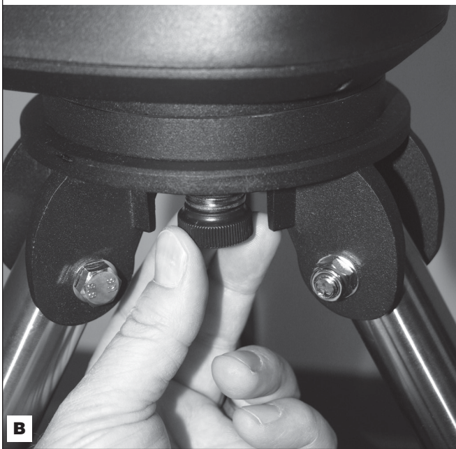
Abbildung 4. Der Montierungsarm ist an der Stativplattform mit drei unverlierbaren Schrauben befestigt. A) Richten Sie die Schrauben mit den Löchern an der Unterseite der Arm-Basis aus. B) Ziehen Sie die drei Schrauben an.
