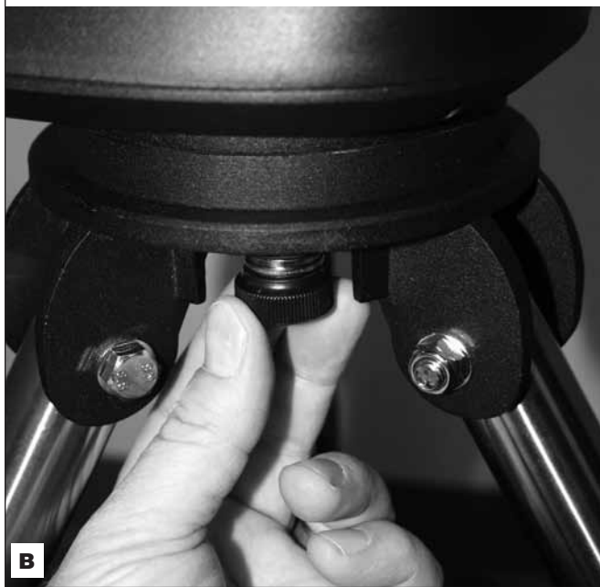
Figura 4. El brazo de la montura se acopla a la plataforma de montaje del trípode con tres tornillos cautivos. A) Alinee los pernos con los agujeros de la parte inferior de la base del brazo. B) Apriete los tres botones.
