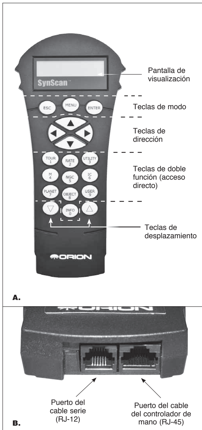
Figura 17. A) Controlador de mano SynScan V4 GoTo, B) Cable del controlador de mano y puerto de cable serie en el extremo inferior del controlador.
