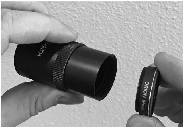
**Figura 21.** Los oculares Kellner tienen cilindros roscados que admiten filtros opcionales de 31,75 mm de Orion. Un filtro lunar es útil para reducir el resplandor y ver más detalles de la superficie lunar.
