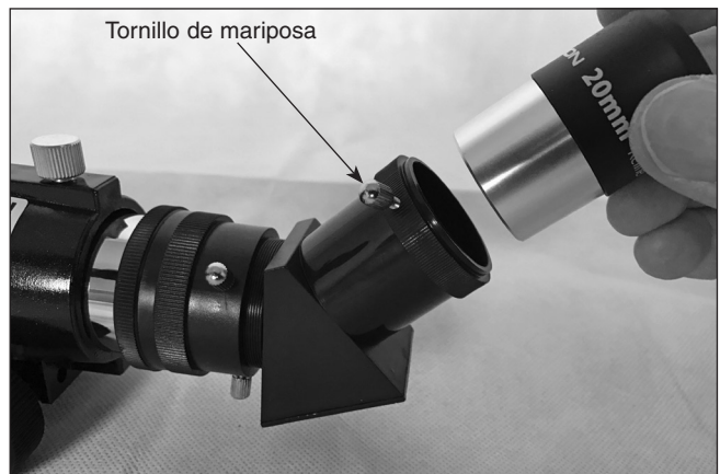
Figura 11. Inserte el ocular en la diagonal y sujétela con el tornillo de mariposa.
