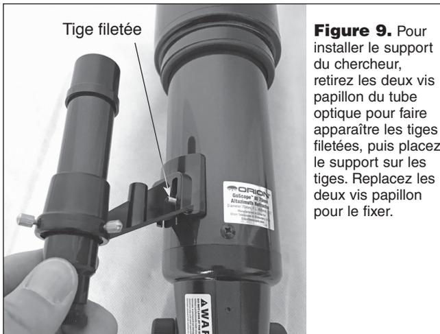
**Figure 9.** Pour installer le support du chercheur, retirez les deux vis papillon du tube optique pour faire apparaître les tiges filetées, puis placez le support sur les tiges. Remplacez les deux vis papillon pour le fixer.
